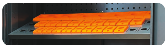
Инструментальная полка с пластиковыми держателями: SK, BT, HSK, Capto, VDI
